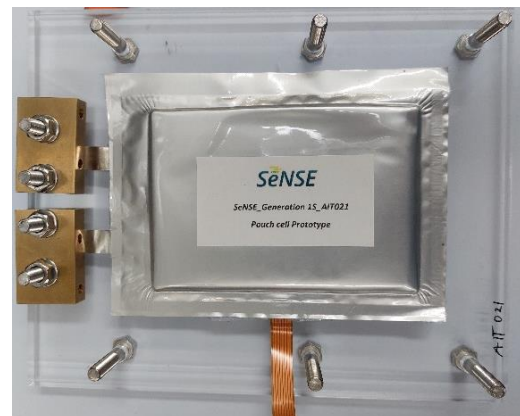
Abbildung eines im Rahmen des SeNSE-Projektes entwickelten Batterieprototypen der ersten Generation im Pouchzellformat mit integrierter Sensorik.
