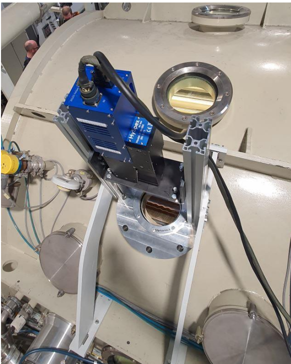
Detailaufnahme der installierten VIS-NIR Hyperspektralkamera am CoFlex R2R Sputter Coater.
