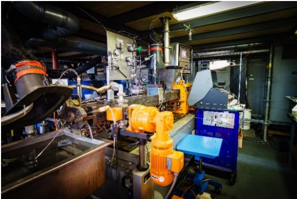
Pilotanlage zur extraktiven Extrusion.
