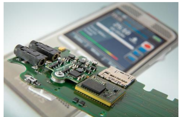
Modularisierung auf Leiterplattebene: Digitaler Sprachrekorder mit eingebetteten Komponenten in Modulen.
