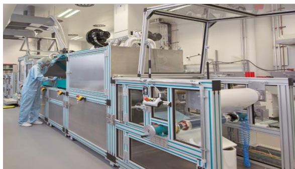
Rolle-zu-Rolle Prozessführung für die Herstellung elektrochromer Folien aus nasschemisch abgeschiedenen Schichten. (© Fraunhofer ISC)
