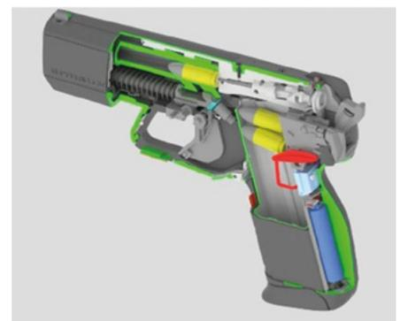
Schematische Darstellung Prototyp – © Armatix GmbH
