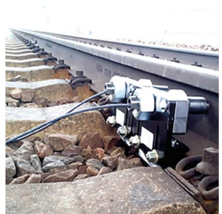
Sensor zur Diagnose über den Schienenzustand – © SENVISYS
