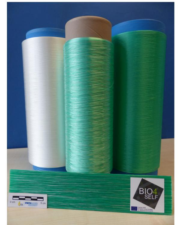
Eigenverstärkter Faserverbundkunststoff (eFVK) aus PLA und PLA-Fasern
