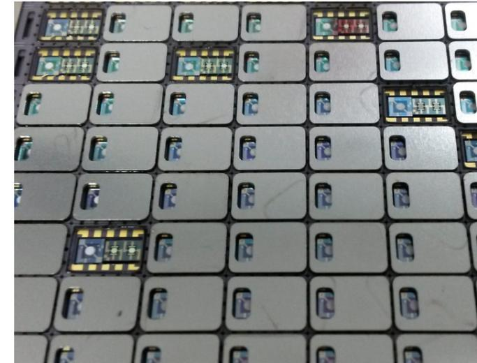
Batch aus Sensor-Präkonzentratoren-Systemen, zum Teil abgedeckt mit exakt positioniertem Gaszutritt
