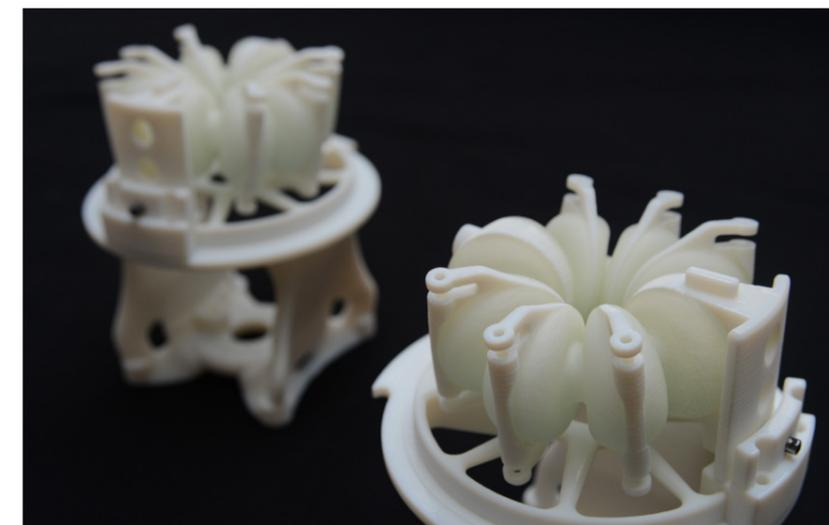
Der pneumatische Festo Roboter Aktuator wurde in einem Schritt mit maximaler Funktionsintegration gedruckt
