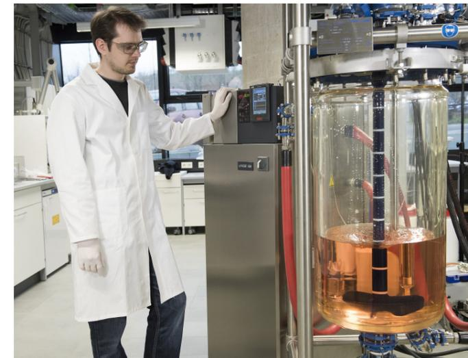
Der Rührreaktor für Partikelsynthesen im Maßstab 100 Liter
