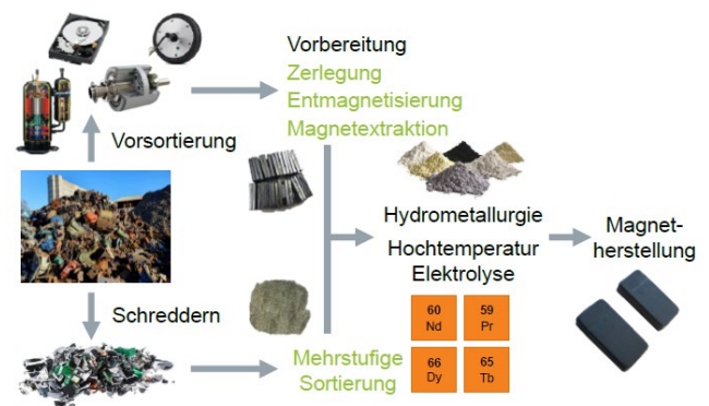
Prozesskette vom End-of-Life-Produkt zum neuen Magneten
