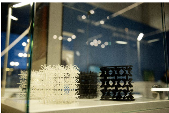
Durch 3D-Extrusion gedruckte Strukturen.
