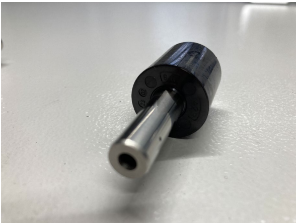
Rotor aus dem Passenger Projekt, bei dem das Material direkt auf der Welle aufgetragen ist.
